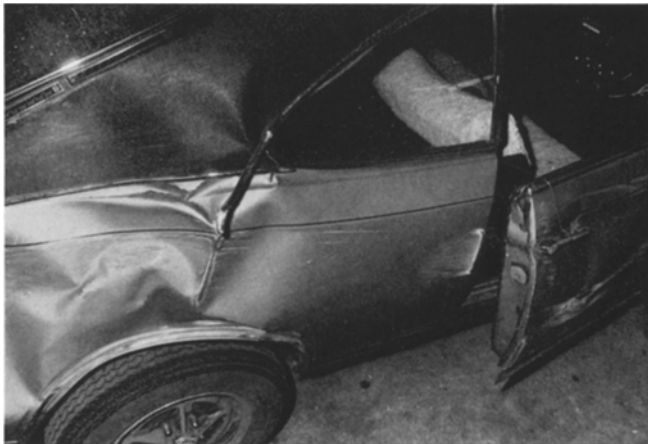
Abb. 2. Wagen mit aufgesprungener Beifahrertür
